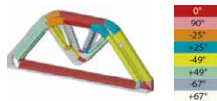
6. ábra: Szegmentált szálirányok és a többsítített erősítőrétegek
