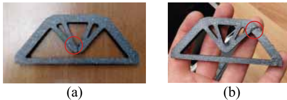
10. ábra: A piros karikák mutatják a próbatestek tönkrementeli helyeit. Átszakadás erőbevezetésnél (a) és berogyás az erőfolyam egyik törési pontjánál (b)
